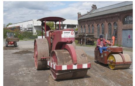
Bei schönem Wetter konnten wir erstmals unsere große Scheid-Walze (deren Hersteller zum Mülheimer Stinnes-Konzern gehörte) nach der technischen Instandsetzung der Kraftstoffanlage, der Hydraulik sowie der Elektrik wieder in Betrieb nehmen. Zusammen mit der kleinen Scheid-Walze und dem O&K-Radlader haben wir unseren Parkplatz wieder instandgesetzt.
