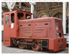
In den letzten Wochen wurden weitere fehlende Teile nachgefertigt und andere Baugruppen aufgearbeitet. Derzeit wird alles probeweise montiert, sodass die 1957 in Mülheim gebaute Lok einen kompletten Eindruck macht. Sorgen macht uns noch die Einspritzpumpe, die derzeit in einer Fachwerkstatt überholt wird.
