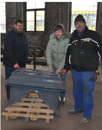
Historischer Rauchabzug vor und nach der Aufarbeitung in unserer Schlosser-Werkstatt. Die Rauchabzüge werden auch für den künftigen Brandschutz benötigt.
